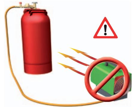
Pour éviter tout givrage de la ou des bouteilles de gaz, l'alimentation en gaz doit être conforme à la valeur de raccordement de l'appareil, à la durée de fonctionnement et à la température ambiante des réservoirs d'alimentation.
